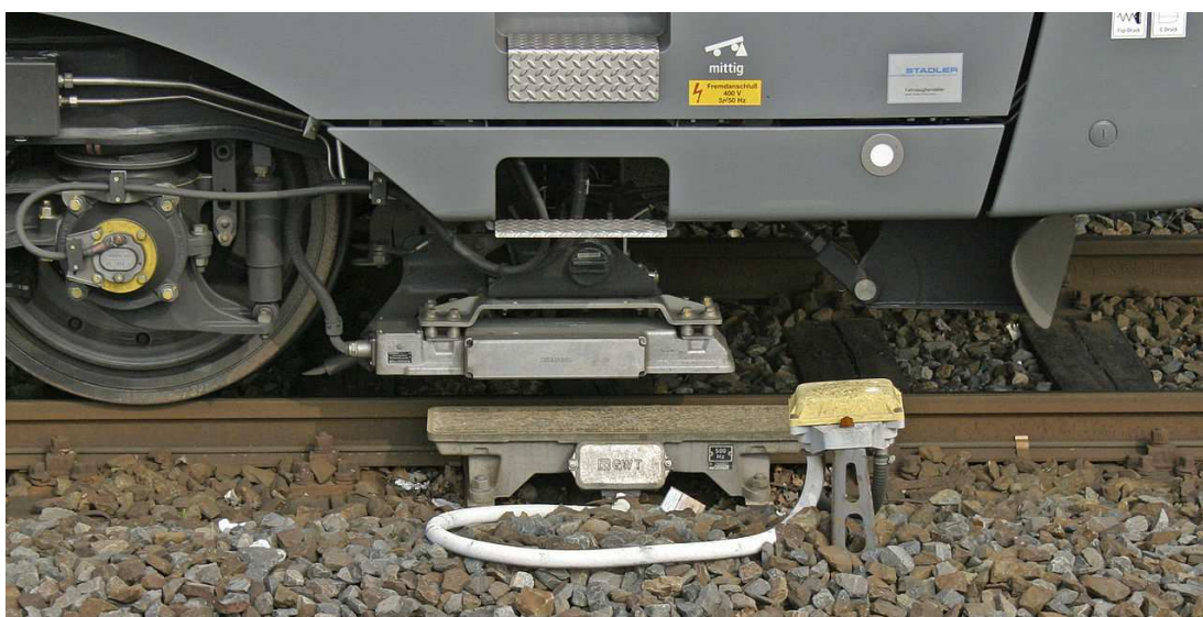
Obrázek 2: Pohled na magnet Indusi a snímač systému PZB
