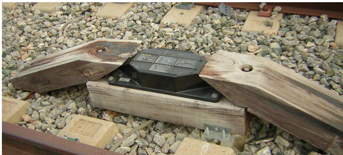
Obrázek 5: Pohled na balízu systému ASFA
